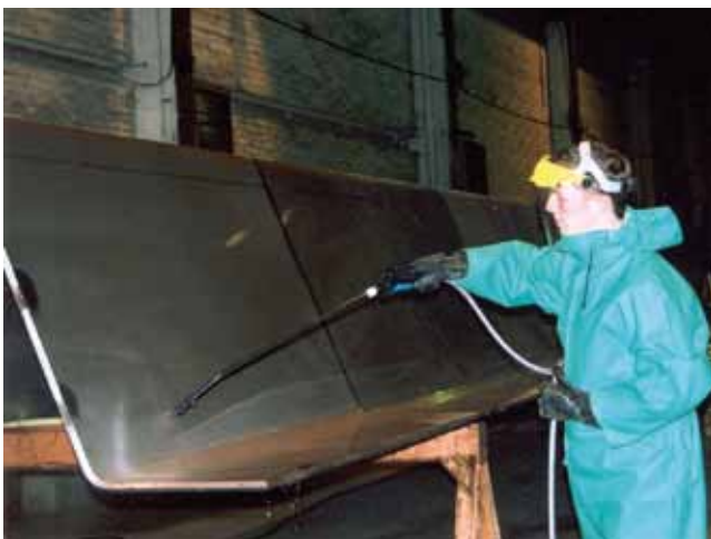
Pasywacja części grodzi zbiornika na chemikalia ze stali nierdzewnej typu duplex
